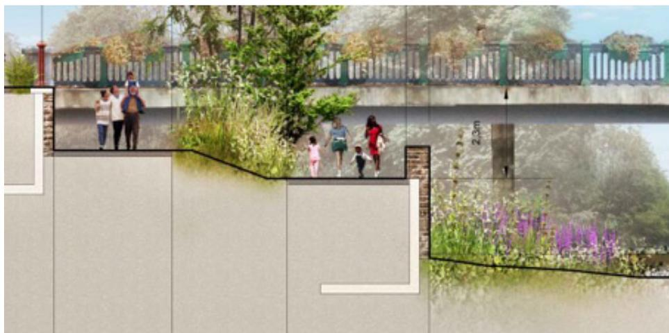
Et, compte tenu du positionnement de cette coupe sur le plan, la rampe, par ailleurs, se prolonge, ce qui conduit à penser que ce muret atteindra, au final, une cote très proche de celle de l'intrados du pont Richelieu.
