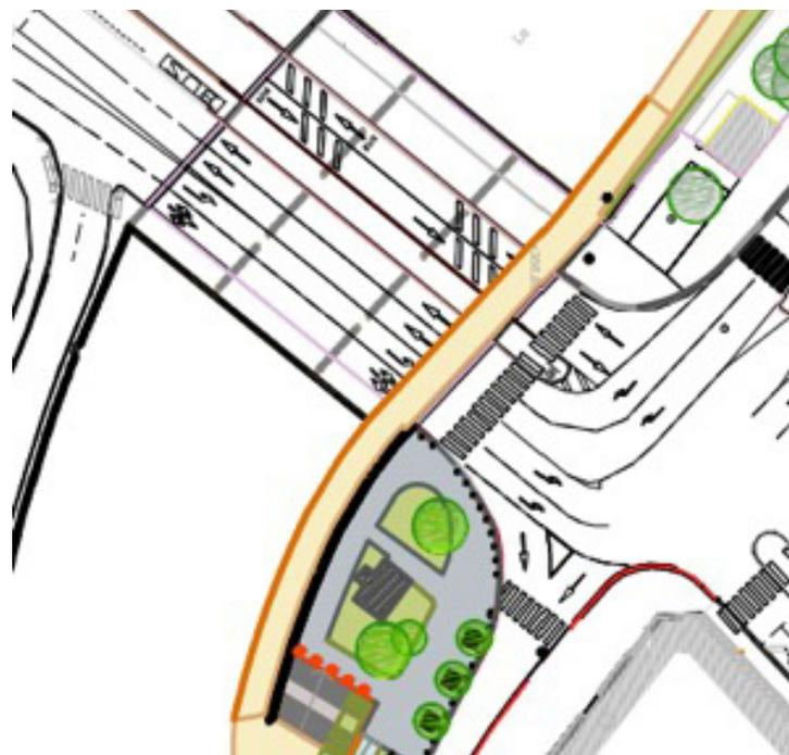
Le trait renforcé orange qui marque la limite de la promenade représente un muret rendu nécessaire par l'abaissement de celle-ci. Les plans de détail montrent que cet abaissement sera d'une vingtaine de centimètres, avec la réalisation d'un muret.
